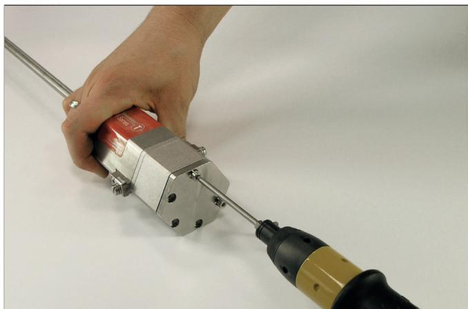
**1** Lösen Sie die fünf M4×10 Schrauben (SW 3).
