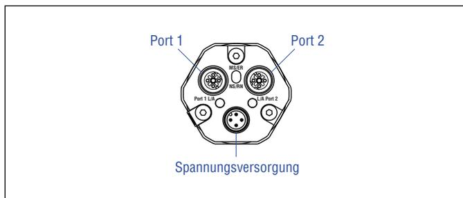
Abb. 76: Position der Anschlüsse
