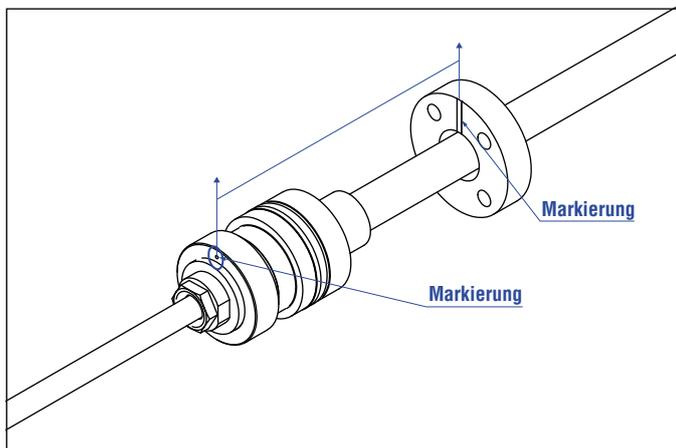
Abb. 63: Magnetausrichtung eines Ringmagneten für den RDV PROFINET mit interner Linearisierung am Beispiel eines »S«-Flansches
