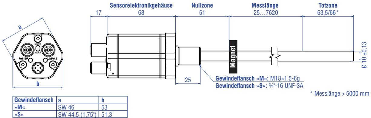
RH5-T-A/F/V – RH5 mit Gewindeflansch 3/4"-16 UNF-3A mit Dichtleiste, Beispiel: Anschlussart D56 (Steckerabgang)
