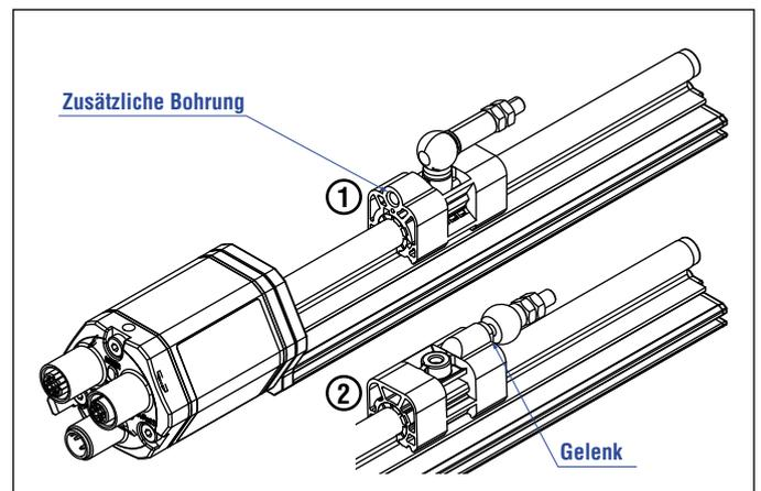
Abb. 62: Magnetausrichtung eines Magnetschlittens für RP5 PROFINET mit interner Linearisierung
