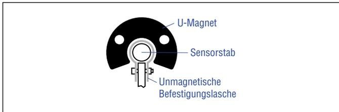
Abb. 49: Beispiel Sensorunterstützung (Artikelnr. 561 481)
