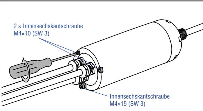
**3. Ziehen Sie den Deckel vom Schutzgehäuse herunter. Schieben Sie dabei die Kabel durch die Kabelverschraubungen.**
