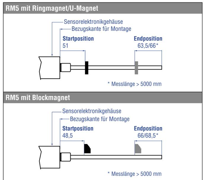
Abb. 52: Start- und Endposition der Magnete für RM5
