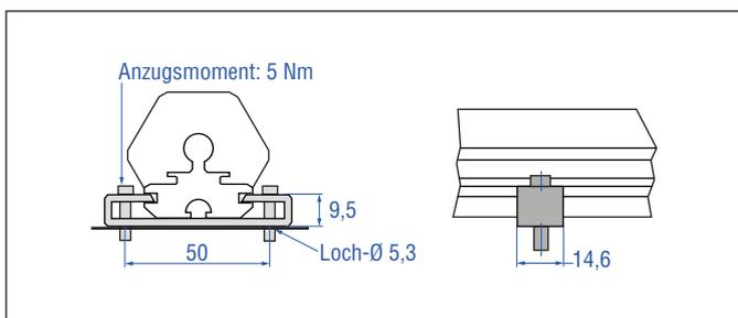
Abb. 26: Montageklammern (Artikelnr. 400 802) mit Zylinderschraube M5×20
