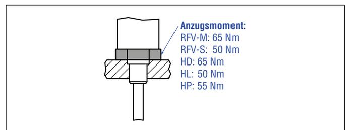
Abb. 31: Einbaubeispiel für Gewindeflansch
