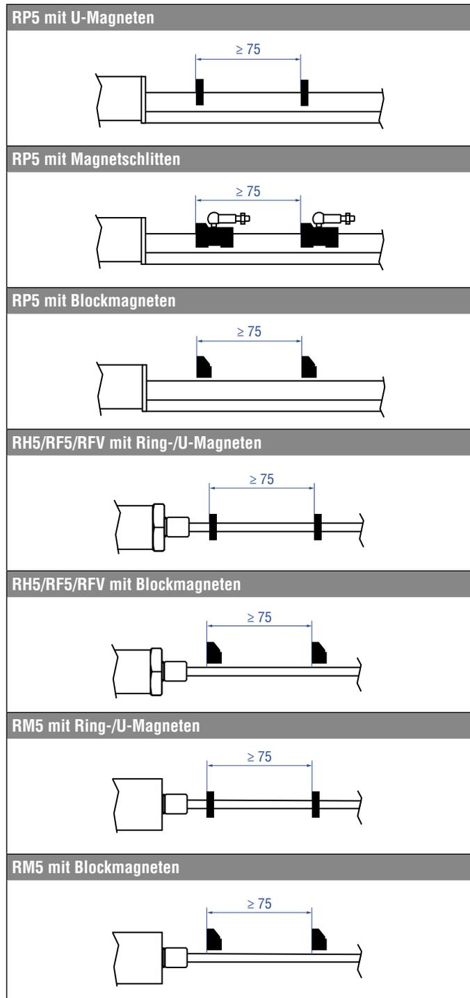
Abb. 58: Minimaler Magnetabstand für Multipositionsmessungen (RH5, RP5, RF5, RFV, RM5)
