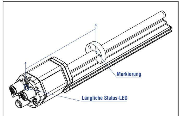
Abb. 61: Magnetausrichtung eines U-Magneten für RP5 PROFINET mit interner Linearisierung
