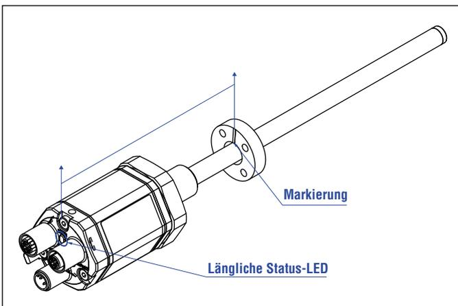
Abb. 60: Magnetausrichtung eines Ringmagneten für RH5 PROFINET mit interner Linearisierung
