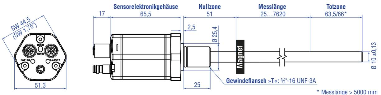
Mechanische Option »B«: Gleitbuchse am Stabende für Gewindeflansch M18×1,5-6g oder 3/4"-16 UNF-3A
