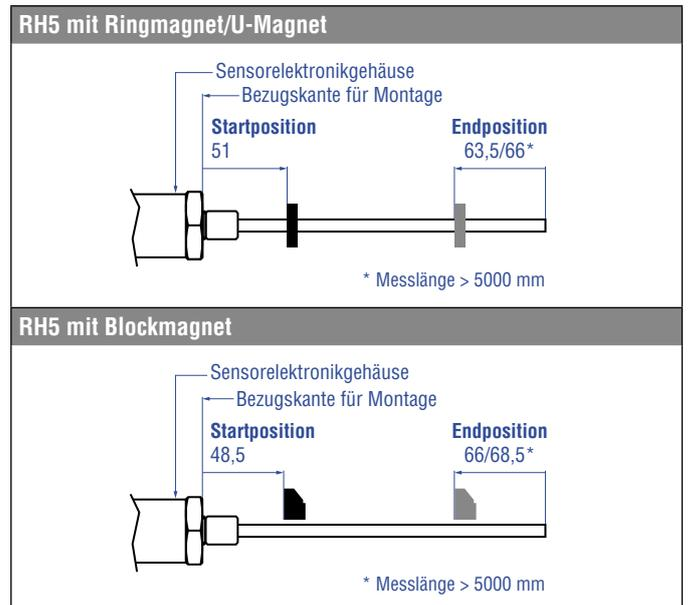
Abb. 51: Start- und Endposition der Magnete für RH5
