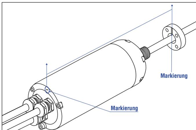
Abb. 64: Magnetausrichtung eines Ringmagneten für RM5 PROFINET mit interner Linearisierung
