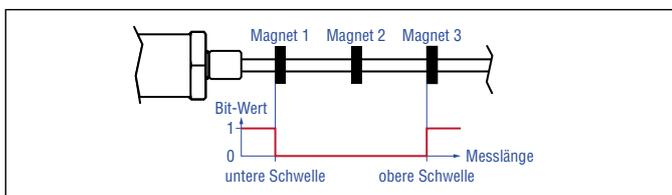
Abb. 97: Überwachung der Schaltpunkte bei der R-Serie V PROFINET bei einem Beispiel mit drei Magneten
