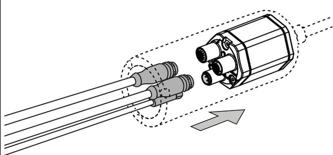
9. Setzen Sie den Deckel auf das Schutzgehäuse.
