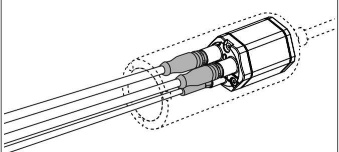
**5. Lösen Sie die Schrauben im Deckel des Sensors.**
