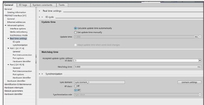
Abb. 83: Einstellung des IRT-Modus am Sensor
