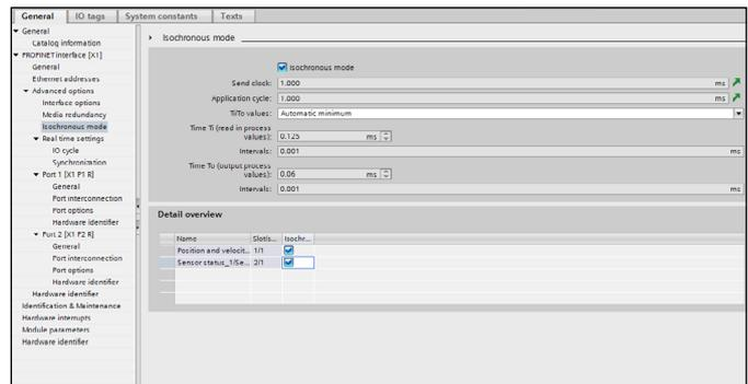
Abb. 84: Aktivierung des isochronen Modus für die Steuerung
