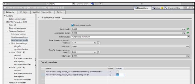
Abb. 102: Aktivierung des isochronen Modus für die Steuerung
