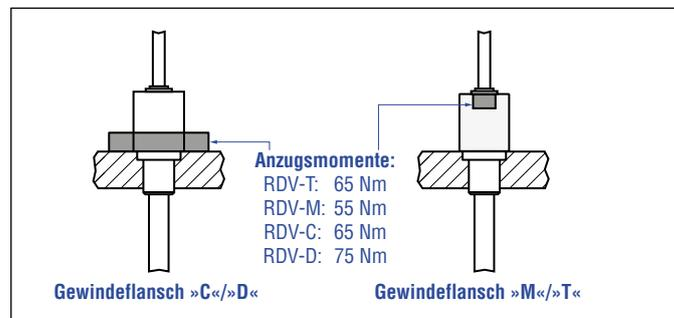
Abb. 37: Einbaubeispiel für Gewindeflansch »C« / »D«, »M« / »T«
