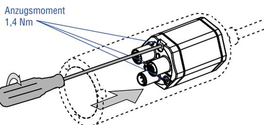
8. Befestigen Sie die Stecker am Basissensor im Schutzgehäuse.
