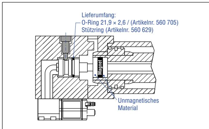
Abb. 42: Einbaubeispiel Steckflansch »S« und Sensorelektronik mit Bodenanschluss
