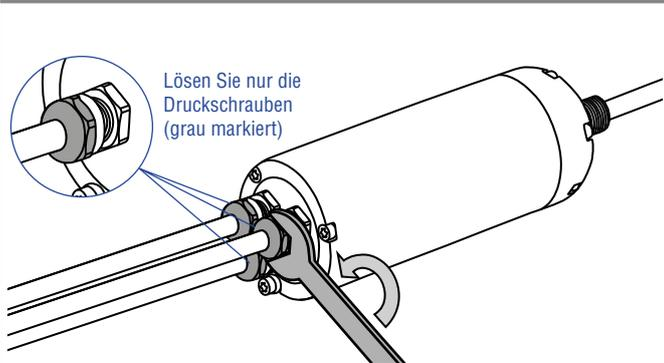
**2. Lösen Sie die Schrauben im Deckel des Schutzgehäuses.**
