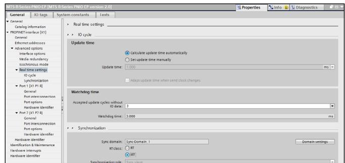
Abb. 101: Einstellung des IRT-Modus am Sensor
