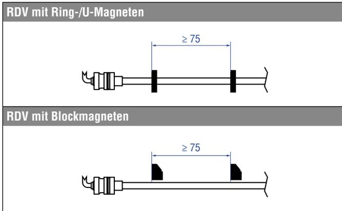
Abb. 59: Minimaler Magnetabstand für Multipositionsmessungen (RDV)
