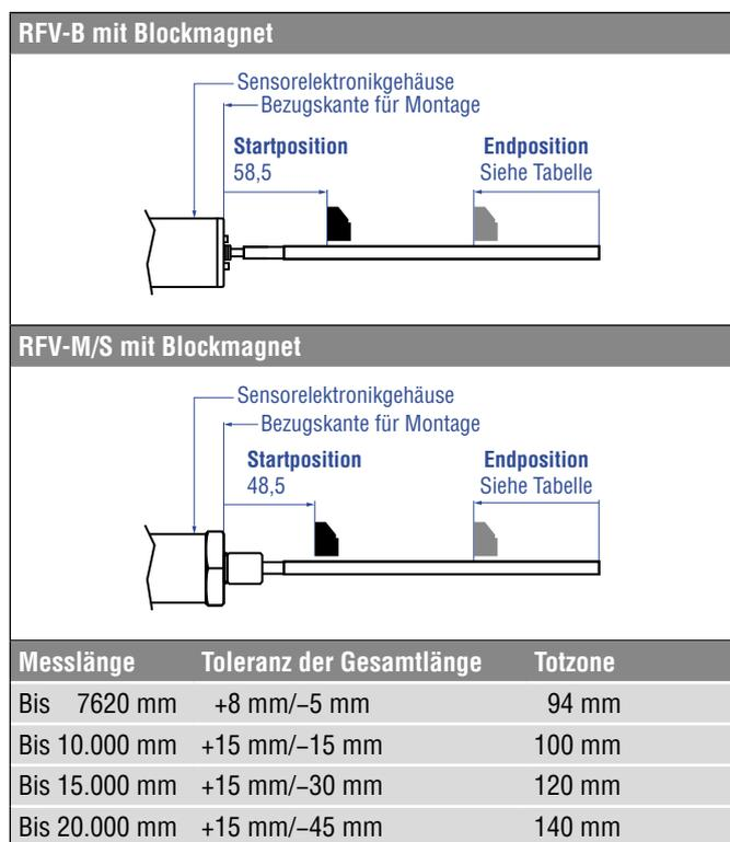
Abb. 55: Start- und Endposition der Magnete für RFV mit Blockmagnet
