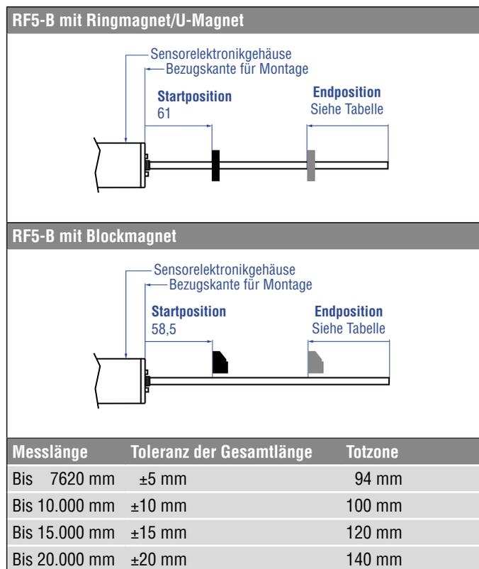
Abb. 53: Start- und Endposition der Magnete für RF5
