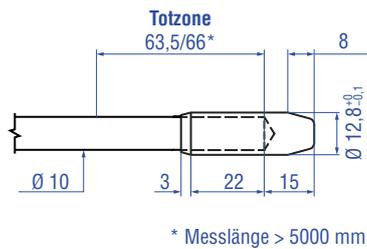
Mechanische Option »M«: M4-Gewinde am Stabende für Gewindeflansch M18×1,5-6g oder 3/4"-16 UNF-3A
