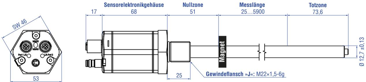
RH5-B-A/F/V – RH5 Basissensor (nur für den Austausch), Beispiel: Anschlussart D58 (Steckerabgang)
