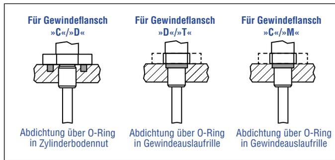
Abb. 38: Möglichkeiten der Abdichtung
