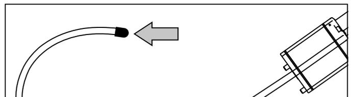
Abb. 68: Transportkappe am RH5-B-F vor dem Einbau entfernen
