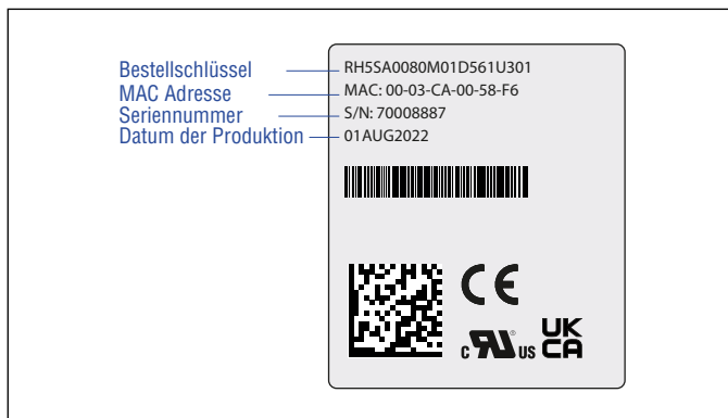
Abb. 1: Beispiel eines Typenschilds eines R-Serie V RH5 POWERLINK Sensors
