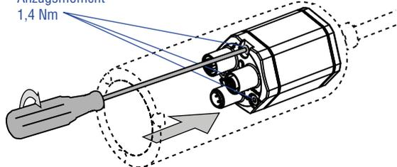
8. Befestigen Sie die Stecker am Basissensor im Schutzgehäuse.
