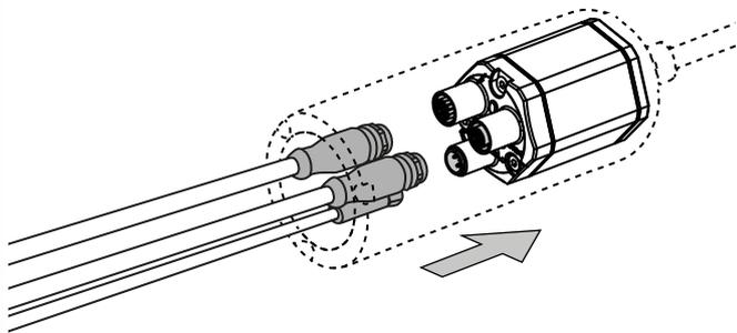
9. Setzen Sie den Deckel auf das Schutzgehäuse.
