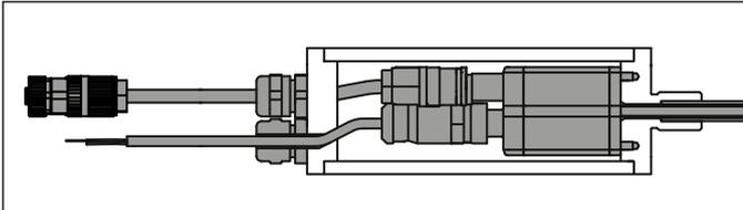
Abb. 69: Basissensor im Schutzgehäuse des RM5
