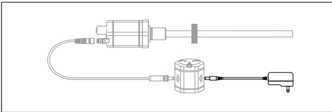
Abb. 84: Anschluss des TempoLink® Sensorassistenten über das Steckernetzteil mit Steckeradaptern
