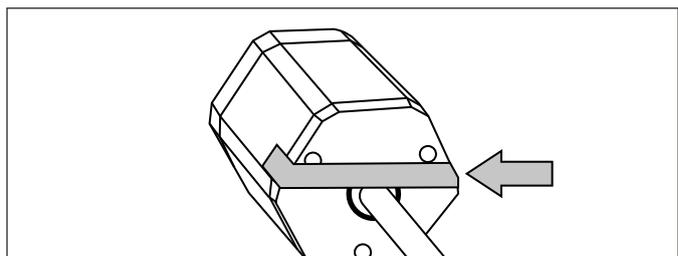
Abb. 67: Klebestreifen entfernen
