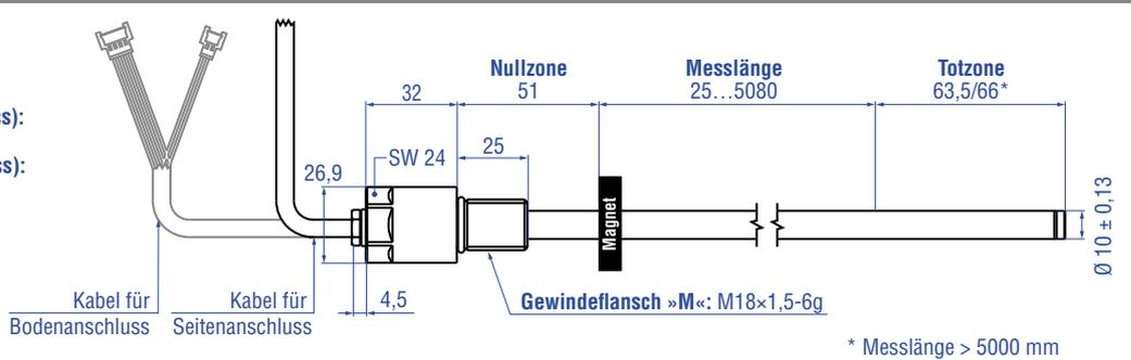
**Gewindeflansch »T« (für Boden- oder Seitenanschluss)**
