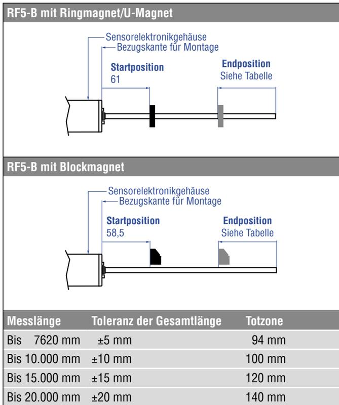
Abb. 55: Start- und Endpositionen der Magnete für RF5
