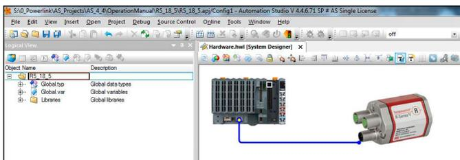
Abb. 105: R-Serie V POWERLINK Sensor mit Steuerung verbinden
