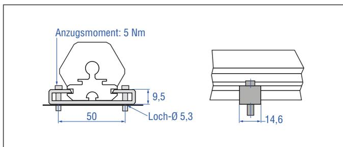
Abb. 4: Montageklammern (Artikelnr. 400 802) mit Zylinderschraube M5×20
