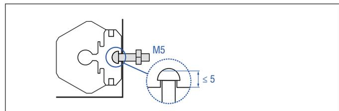
Abb. 5: Nutenstein M5 in T-Bodennut (Artikelnr. 401 602)
