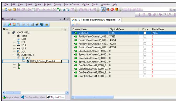
Abb. 99: „I/O-Mapping“ des Sensors mit geänderter Node-ID
