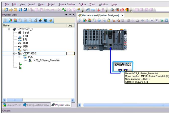
Abb. 93: Aufbau der Hardware in „Automation Studio“
