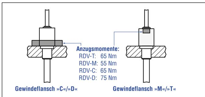
Abb. 37: Einbaubeispiel für Gewindeflansch »C«/»D«, »M«/»T«
