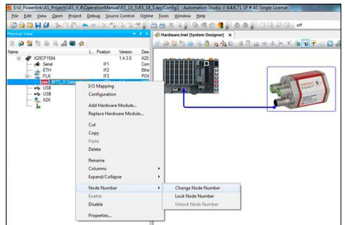
Abb. 106: Setzen der Node-ID des verbundenen Gerätes auf dem Controller
