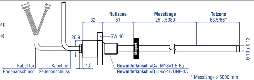
**Gewindeflansch »M« (für Boden- oder Seitenanschluss)**
