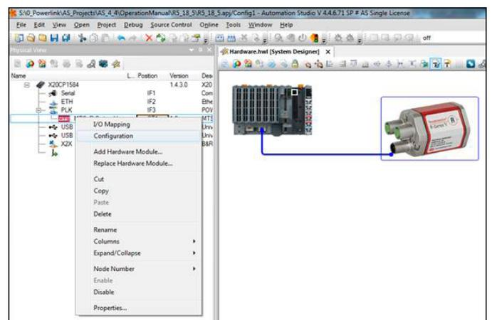
Abb. 107: Setzen der Node-ID des verbundenen Gerätes auf dem Controller
