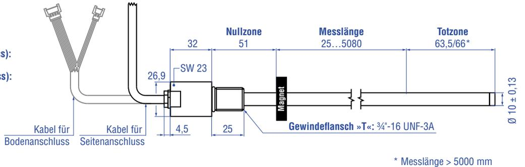
**Steckflansch »S« (für Boden- oder Seitenanschluss)**
