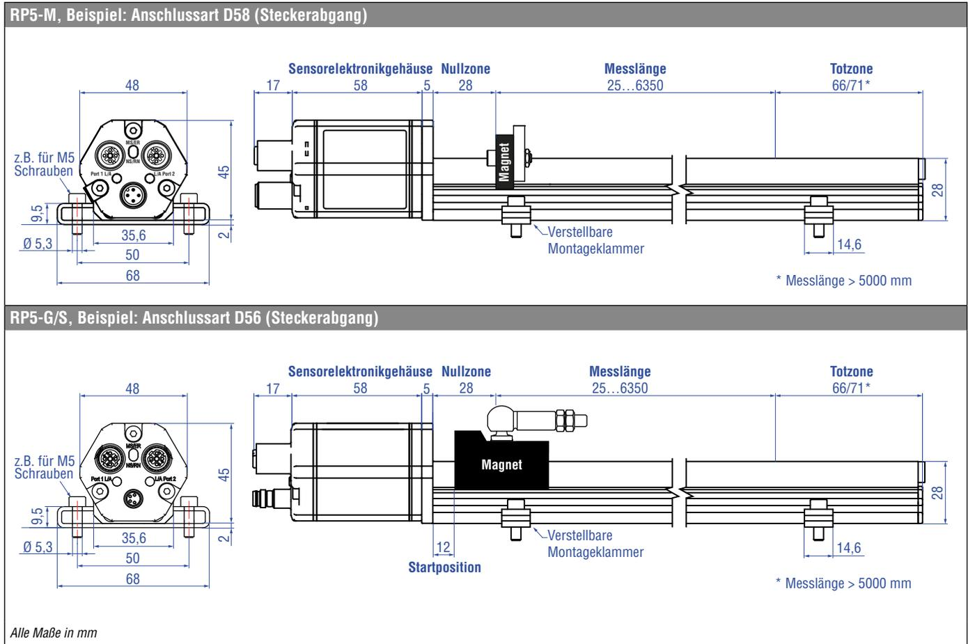
Abb. 3: Temposonics® RP5 mit U-Magnet und Magnetschlitten
