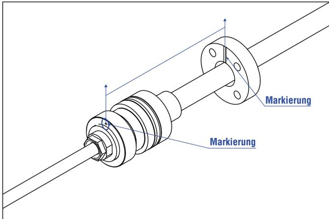
Abb. 63: Magnetausrichtung eines Ringmagneten für RDV EtherCAT mit interner Linearisierung am Beispiel eines »S«-Flansches
