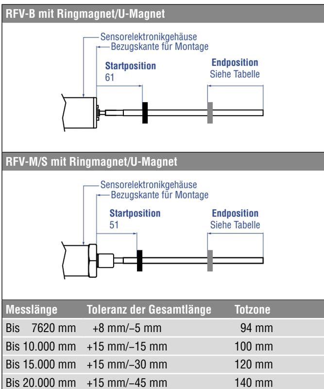
Abb. 54: Start- und Endposition der Magnete für RFV mit Ring- und U-Magneten
