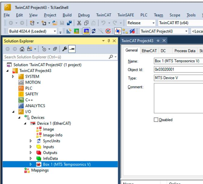
Abb. 86: R-Serie V EtherCAT® als „Box 1“ im Netzwerk gefunden
