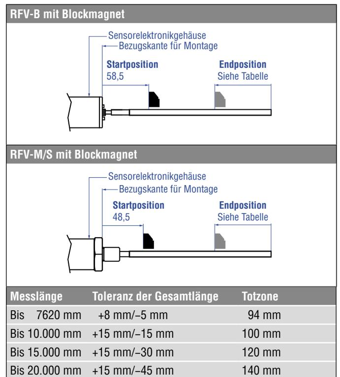
Abb. 55: Start- und Endposition der Magnete für RFV mit Blockmagnet
