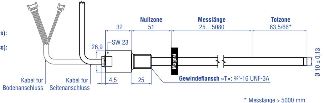
**Steckflansch »S« (für Boden- oder Seitenanschluss)**
