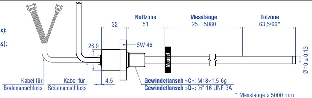
**Gewindeflansch »M« (für Boden- oder Seitenanschluss)**
