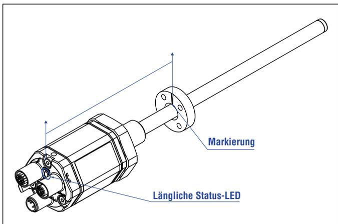
Abb. 60: Magnetausrichtung mit Ringmagnet für RH5 EtherCAT® mit interner Linearisierung
