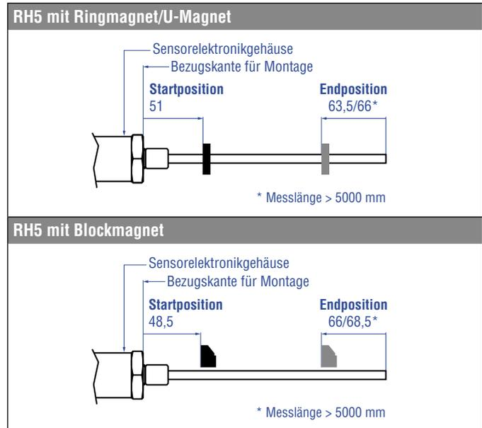
Abb. 51: Start- und Endposition der Magnete für RH5
