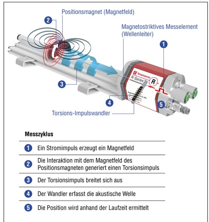
Abb. 2: Laufzeit-basiertes magnetostriktives Positionsmessprinzip
