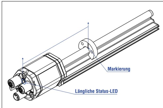
Abb. 61: Magnetausrichtung mit U-Magnet für RP5 EtherCAT mit interner Linearisierung
