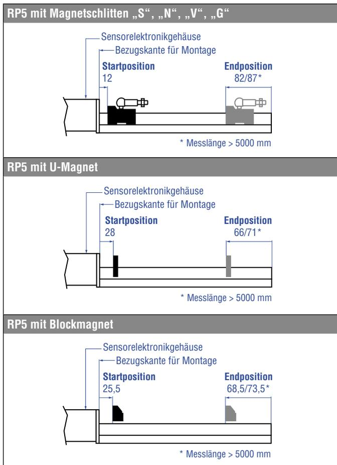
Abb. 50: Start- und Endposition der Magnete für RP5
