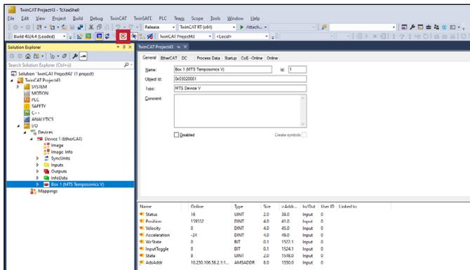
Abb. 89: Anzeige aktueller Werte nach Starten des Free Run-Modus
