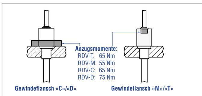
Abb. 37: Einbaubeispiel für Gewindeflansch »C«/»D«, »M«/»T«
