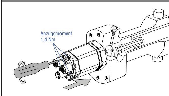
Abb. 66: Austausch des Basissensors am Beispiel eines RH5 Sensors, Teil 2
