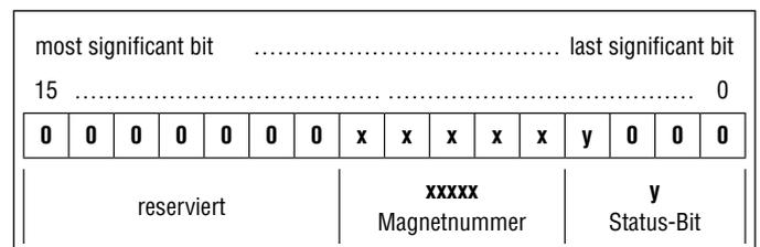
Abb. 98: Aufbau des Status-Objekts
