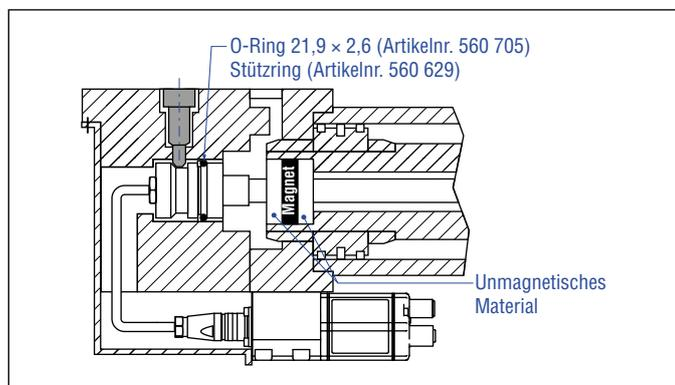
Abb. 43: Einbaubeispiel Steckflansch »S« und Sensorelektronik mit Seitenanschluss
