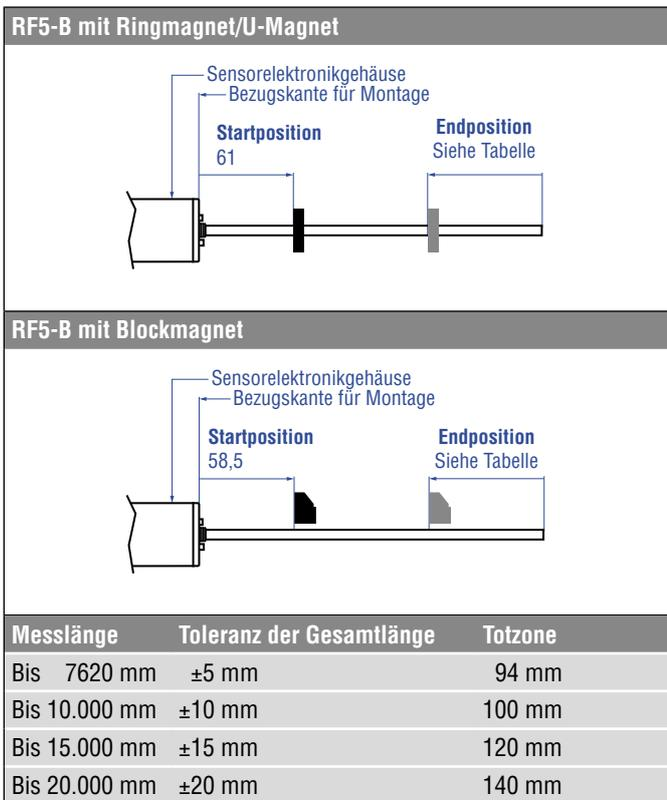
Abb. 53: Start- und Endpositionen der Magnete für RF5
