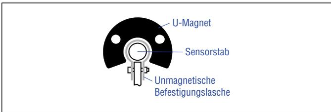
Abb. 49: Beispiel Sensorunterstützung mit Befestigungsglasche (Artikelnr. 561 481)
