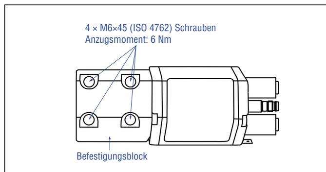
Abb. 44: Befestigung des RDV Sensorelektronikgehäuses (Beispiel Bodenanschluss)
