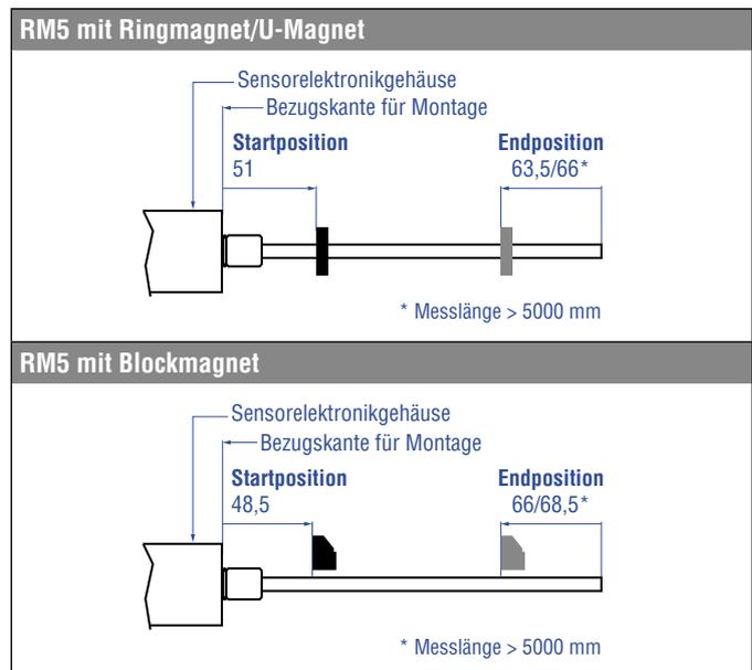
Abb. 52: Start- und Endposition der Magnete für RM5
