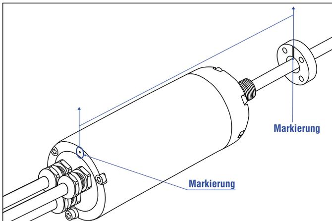
Abb. 64: Magnetausrichtung eines Ringmagneten für RM5 EtherCAT® mit interner Linearisierung
