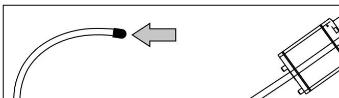
Abb. 68: Transportkappe am RH5-B-F vor dem Einbau entfernen
