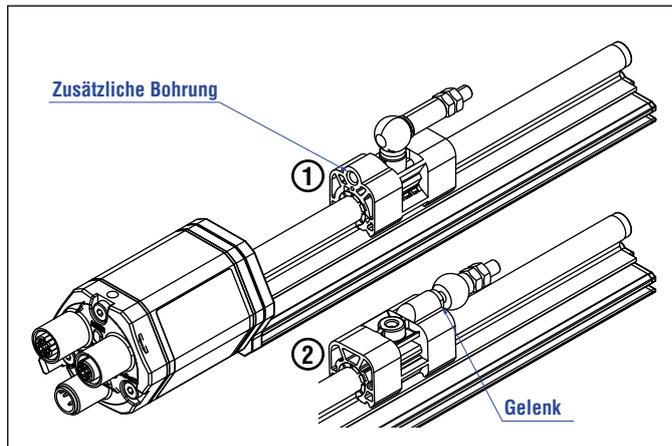
Abb. 62: Magnetausrichtung mit Magnetschlitten für RP5 EtherCAT® mit interner Linearisierung
