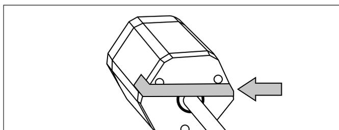
Abb. 67: Klebestreifen entfernen
