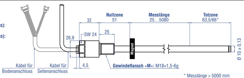
**Gewindeflansch »T« (für Boden- oder Seitenanschluss)**
