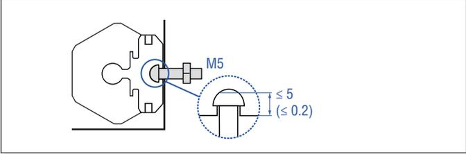
Fig. 5: T-slot nut M5 (part no. 401 602)
