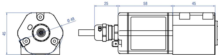
**RDV mit Seitenanschluss, Beispiel: Anschlussart TXX (gerader Kabelabgang)**
