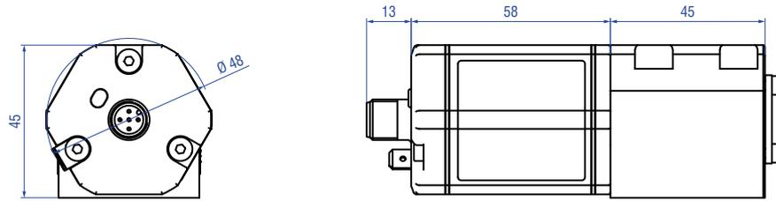
**RDV mit Seitenanschluss, Beispiel: Anschlussart HXX/RXX (gerader Kabelabgang)**
