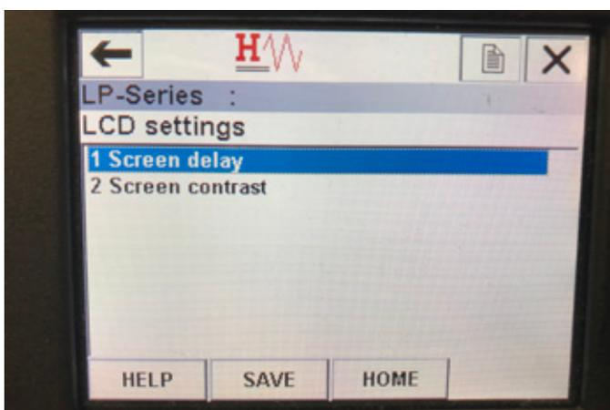
Abb. 30: Menü „LCD settings“ (LCD-Einstellungen)
