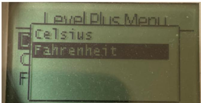
Abb. 41: Anzeige „Temp Unit“ (Einheit Temperatur)
