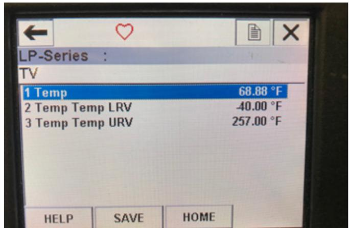
Abb. 19: Menü „TV“ (Tertiary Variable, Tertiäre Variable)
