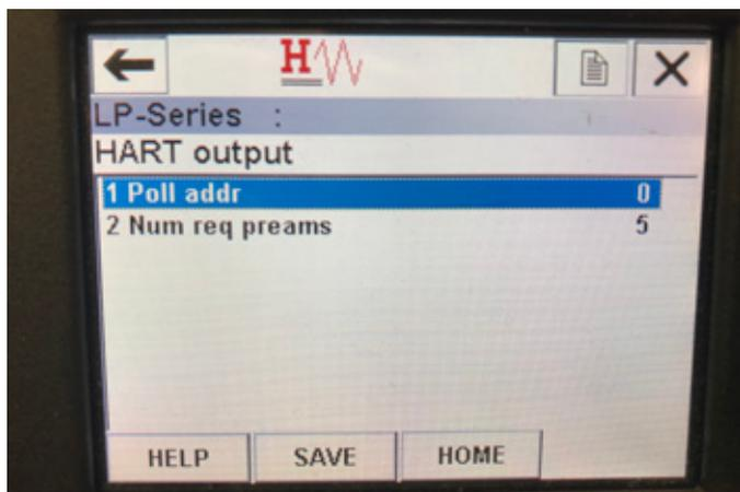
Fig. 35: Pantalla de menú de salida de HART®
