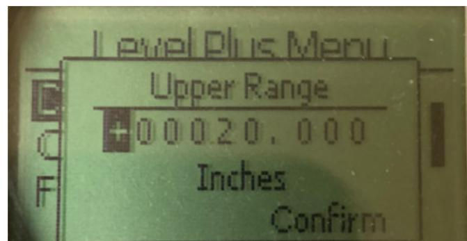
Abb. 48: Anzeige „Int URV (20 mA)“ (Trennschicht oberer Bereichswert (20 mA))
