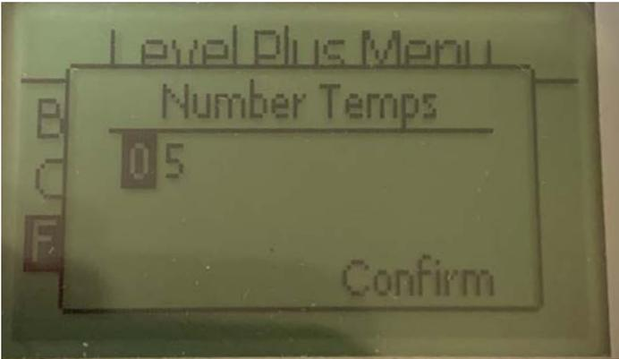
사용자가 레벨 트랜스미터가 찾고 있는 온도 측정 포인트 수를 조정할 수 있습니다. 주문한 온도 센서의 물리적 수를 조정하지 마십시오. Modbus는 온도 센서 옵션이 1, 5, 12 또는 16개입니다.
