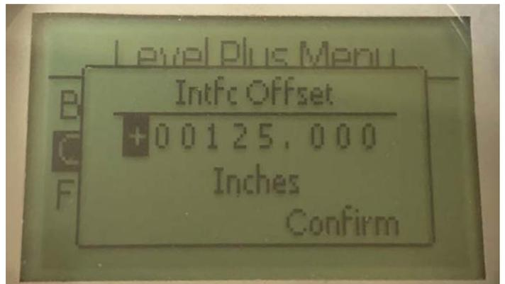
공장 기술 지원을 바탕으로만 사용됩니다. 인터페이스 레벨이 비활성화 상태인 경우, 섹션 9.2.1.2.3.2에 설명된 것처럼 디스플레이에 Not Enabled(활성화되지 않음)으로 표시됩니다.
