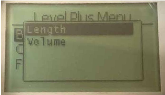
**Length [長さ]** – 選択した単位でレベル計測を表示するためにディスプレイを変更します。
