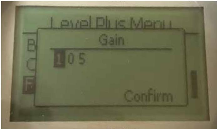
ゲインは呼び掛け信号パルスの強度です。Temposonicsではあらゆる長さに対して同じ電子機器を使用し、注文長に基づいて信号を調整しています。調整する場合は、Temposonicsテクニカルサポートまでご相談ください。
