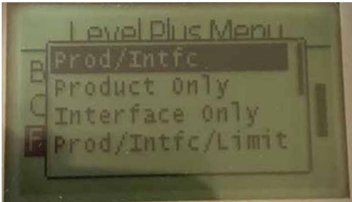
Product Only [液面レベルのみ]、Interface Only [境界面レベルのみ]、およびProduct/Interface [液面/境界面レベル]を選択し、Limitオプションを追加することができます。Limitオプションは、LevelLimit液面トランスミッターでのみ有効化されます。
