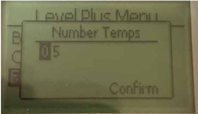
液面トランスミッターが探索する温度計測ポイントの数を調整することができます。発注された温度センサーの物理的な数を調整することはできません。Modbusでは、1個、5個、12個、または16個の温度センサーを選択できます。
