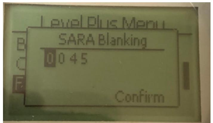
Consente all'utente di regolare la finestra di blanking per l'impulso di interrogazione. RefineME e SoClean dovrebbero essere a 25 e Tank SLAYER e CHAMBERED a 40. Questi parametri non devono essere modificati senza consultare l'Assistenza tecnica di Temposonics.
