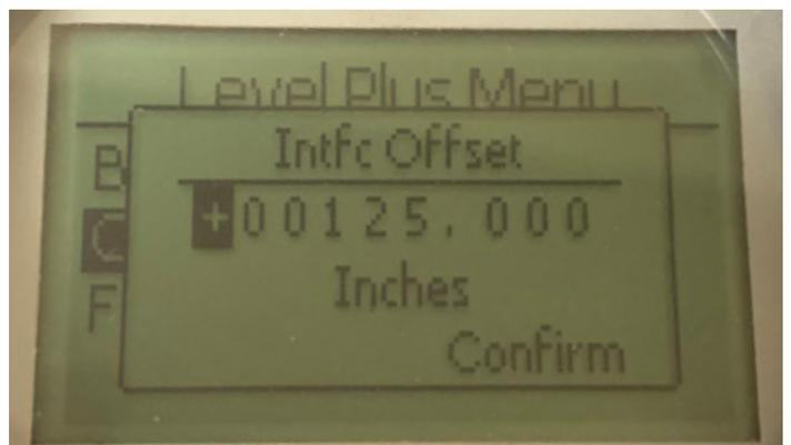
Utilizzato solo in base al supporto tecnico di fabbrica. Se il livello di interfaccia è disabilitato mostrerà Non abilitato sul display come mostrato nella sezione 9.2.1.2.3.2.
