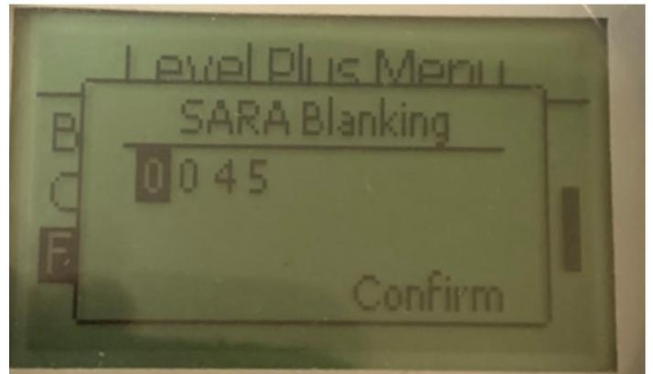
Permite al usuario ajustar la ventana de obturación del pulso de interrogación. RefineME y SoClean debería estar a 25, y Tank SLAYER y CHAMBERED (con compartimentos) a 40. No lo ajuste sin hablar con el soporte técnico de Temposonics.
