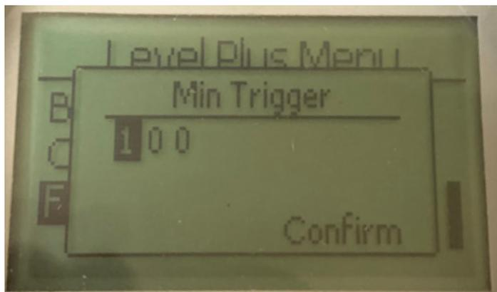
Permite al usuario ajustar el umbral que debe cumplir la señal de retorno. La configuración predeterminada es 150. No lo ajuste sin hablar con el soporte técnico de Temposonics.
