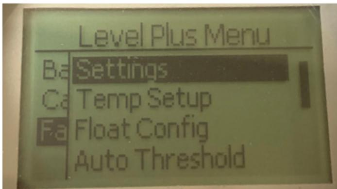
**Settings (Einstellungen)** – Ermöglicht dem Benutzer den Zugriff auf die Werkseinstellungen.
