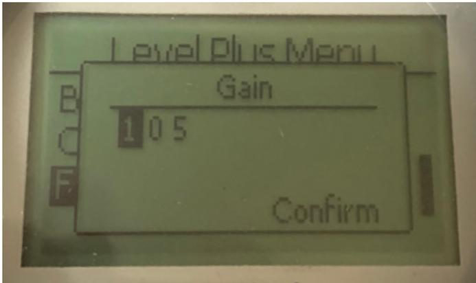
Die Verstärkung ist die Stärke des Abfrageimpulses. Temposonics verwendet die gleiche Elektronik für alle Längen und passt das Signal auf Basis der bestellten Länge an. Nehmen Sie ohne Rücksprache mit dem technischen Support von Temposonics keinerlei Anpassungen an diesen Parametern vor.
