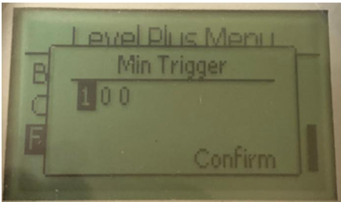
Ermöglicht dem Benutzer die Einstellung des Schwellwerts, den das Rücklaufsignal erfüllen muss. Standardeinstellung ist 150. Nehmen Sie ohne Rücksprache mit dem technischen Support von Temposonics keinerlei Anpassungen an diesen Parametern vor.
