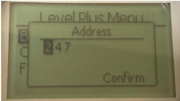
Ermöglicht dem Benutzer das Anzeigen und Ändern der Modbus-Adresse.
