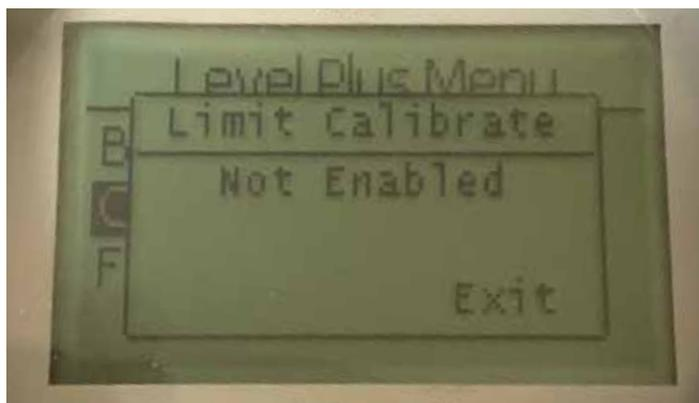
仅在工厂技术支持的帮助下使用。如果启用，将显示数值，如章节9.2.1.2.1.2所示。当无法使用时，将显示Not Enabled (未启用)，如上图所示。
