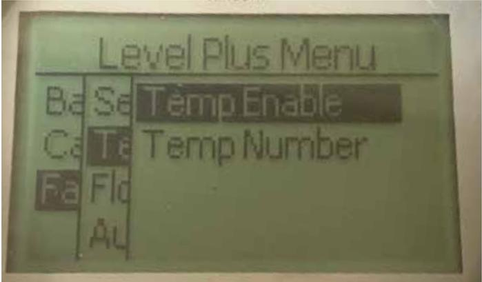
**Temp Enable (启用温度)** – 允许用户打开或关闭温度测量功能。如果设备没有订购温度测量功能，则不能启用此功能。
