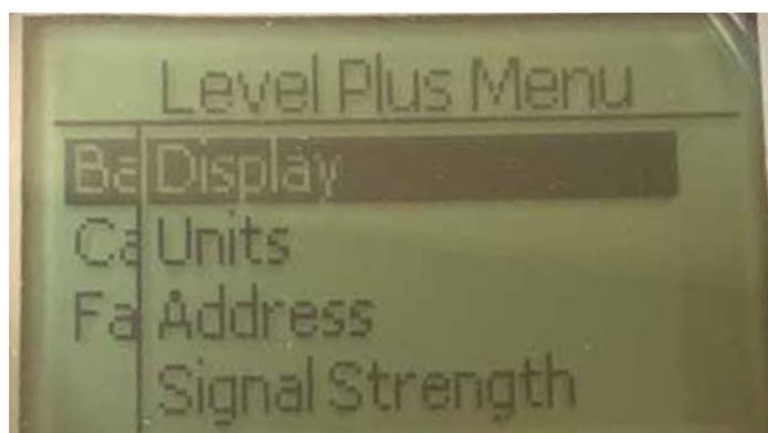
**Display (显示)** – 允许用户在工程单位、毫安、及百分比之间切换显示值的类型。
