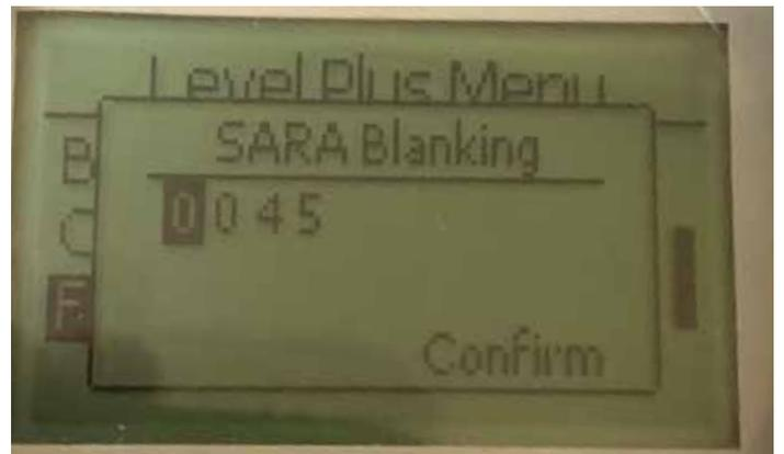
允许用户调节查询脉冲的消隐窗口。RefineME和SoClean应在25，Tank SLAYER和CHAMBERED在40。在咨询Temposonics技术支持人员之前请勿进行调节。
