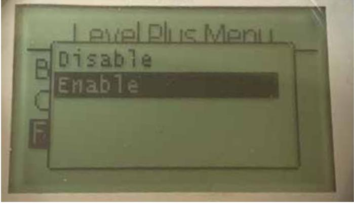
允许用户打开或关闭温度测量功能。如果设备没有订购温度测量功能，则不能启用此功能。
