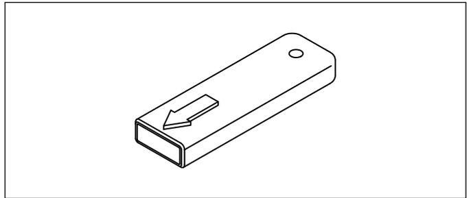
图1: 触控笔 (Temposonics 零件号 404108)
