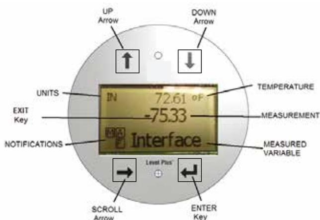
图2: Modbus显示器
