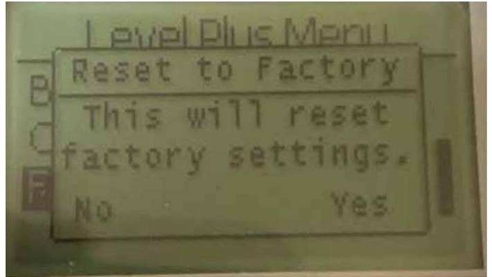
允许最终用户将所有设置复位为Temposonics工厂出厂时的最初设置。主要作为故障处理的第一步。切记，Zero (零) 和 Span (范围) 设定值将复位为出厂设置。
