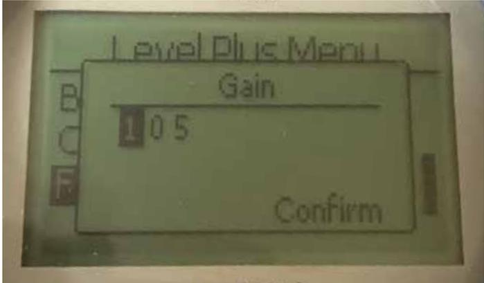
增益是查询脉冲的强度。Temposonics为所有强度使用相同电子元件，然后根据订单长度调节信号。在咨询Temposonics技术支持人员之前请勿进行调节。
