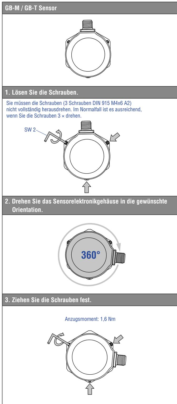
Abb. 18: Sensorelektronikgehäuse bzw. elektrischer Anschluss von GB-M / GB-T ausrichten
