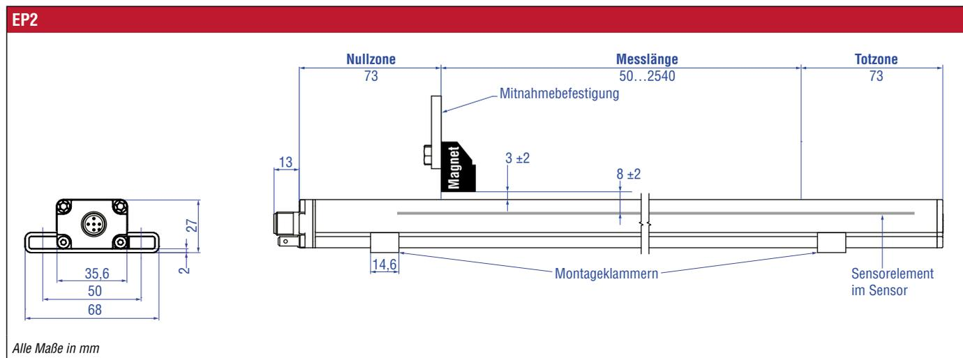
Abb. 3: Temposonics® EP2 mit Blockmagnet
