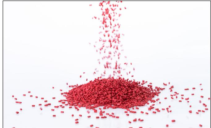
Abb. 2: Kunststoffgranulat zum Spritzgießen oder für die Extrusion
